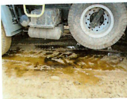
Figura 16 – Simulação de vazamento de óleo hidráulico no Canteiro Avançado
