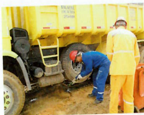
Figura 18 – Uso do pó de serra sobre o vazamento de óleo para absorção do mesmo
