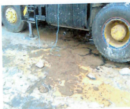
Figura 12 – emergência ambiental envolvendo vazamento de óleo do motor de um guindaste no Canteiro Avançado
